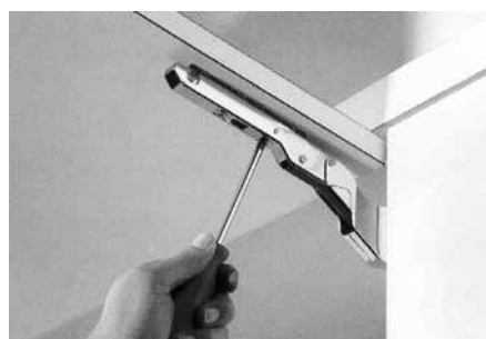
Justera fronten i sid-, djup- och höjddled med skruvmejsel.
